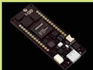
temperatura di funzionamento di grado industriale (da -40° a +85° C). Il modulo Portenta H7 è in grado di eseguire codice Arduino, Python e JavaScript, rendendolo accessibile a un pubblico ancora piú ampio di sviluppatori.
