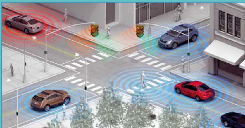
System). Ad oggi l'unica vettura di serie dotata di questo sistema è la nuova Volkswagen Golf che implementa la soluzione di comunicazione salvavita RoadLINK V2X di NXP. Il vantaggio di V2X basato su Wi-Fi è la comunicazione solida, a bassa latenza e in tempo reale, indipendentemente dalle marche di auto: consente la conoscenza e la comunicazione tra auto, infrastrutture stradali come semafori o segnali stradali e altri utenti della strada come ciclisti e pedoni.
