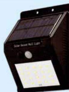
Lampada a LED 4W da esterno con grado di protezione IP44 Non necessita di collegamenti alla rete elettrica per funzionare in quanto dotato di batteria interna e pannello solare per la ricarica. Dispone di sensore crepuscolare e sensore PIR di movimento. Portata del sensore di movimento (PIR) 3-5 metri. Dimensioni 135x100x50 mm, peso 180 grammi.
