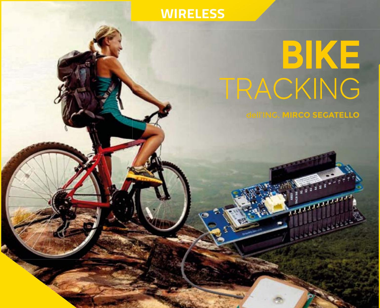
Localizzatore GPS funzionante senza SIM né connessione cellulare, utile come antifurto per biciclette o altri oggetti di valore: sfrutta la rete mobile SigFox per comunicare a distanza i dati di localizzazione e la condizione di allarme.
