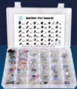
Kit di 37 moduli con sensori per Arduino, Raspberry, robotica ecc.
